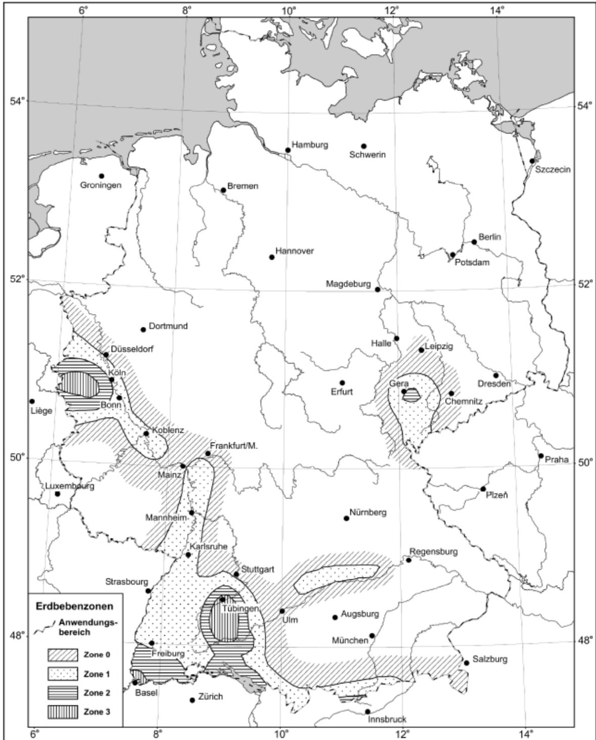
Abbildung 2.2: Erdbebenzonen in Deutschland nach DIN 4149 [65]
