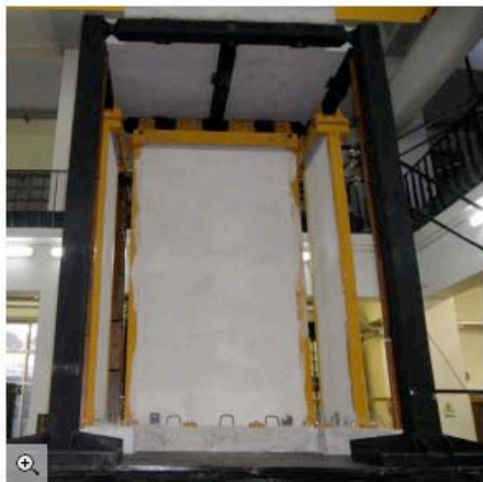
Afbeelding 1 van 2 Siniat - proef met gipswand
